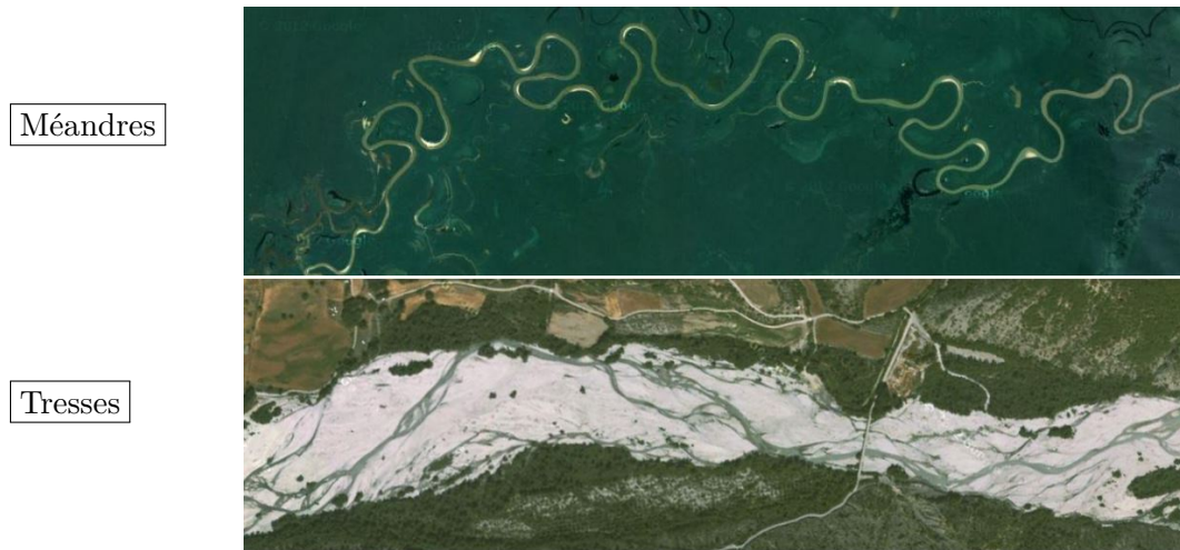
FIGURE 2.2 – Illustration de rivière à méandre (Amazonie, au Brésil) et de rivière en tresses (Nouvelle-Zélande) image Google Earth
