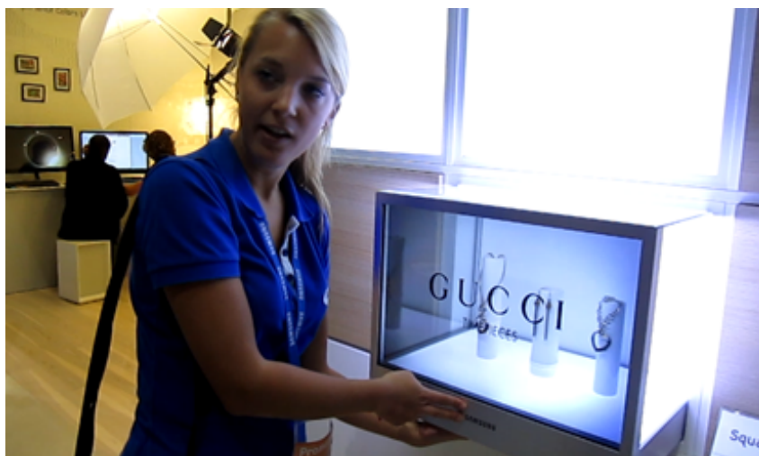
FIGURE 4.10 – Vitrine composée d'un écran transparent présentée par Samsung. Le concept de vitrine augmentée présentée en section 4.5.2 utiliserait un tel dispositif pour afficher des augmentations alignées sur les objets exposés.
