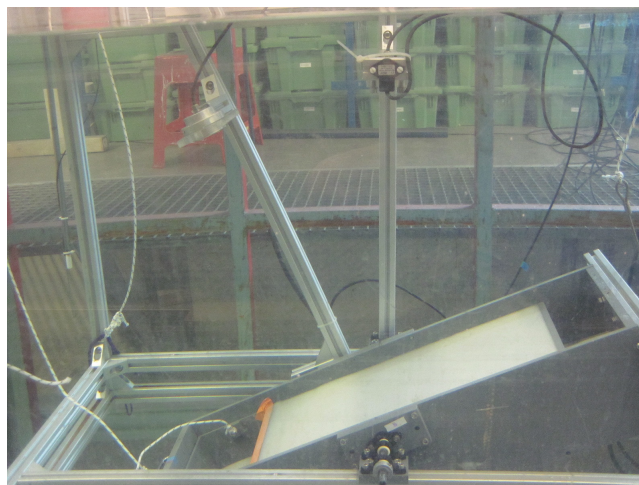
FIGURE 4 – Dispositif expérimental de réflexion/rétrodiffusion acoustique durant la déstabilisation de milieux granulaires immergés.
