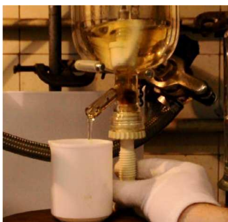
Figure 25 : En fin de réaction, le produit réactionnel est collecté à travers la valve inférieure du réacteur en le coulant dans un bécher en téflon grâce à grande fluidité en fondu du matériau final.
