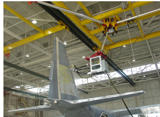
(b) La dernière incarnation de © RoboCrane du NIST de 2006, sur pont roulant et supportant une cabine de peinture
