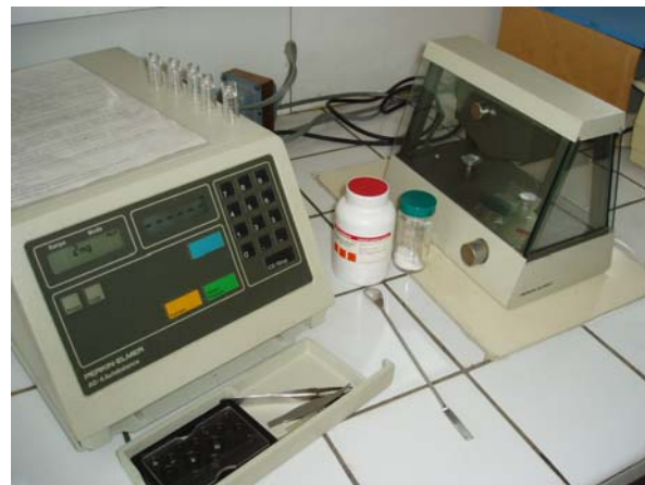
Figure II- 4 Perkin-Elmer AD-4 Autobalance: précision de 0.001 mg
