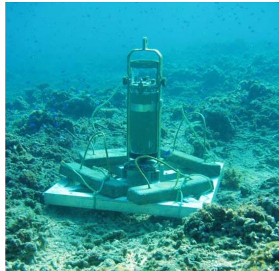
Figure II- 8 Le houlomètre Aanderaa WTR9 en opération
