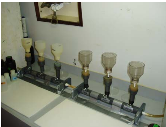
Figure II- 3 Rampe de filtration: la dépression est contrôlée et se fait par effet Venturi
