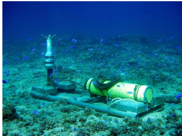
Figure II- 10 La sonde Sontek ADVOcean en opération
