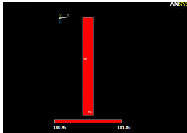
Figure III-11 : Vue sur l'échauffement de la piste dans le modèle 3D structure triplaque sur substrat épais
