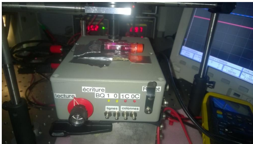
Figure 121 - Photographie du micro tube positionné au-dessus du capteur
