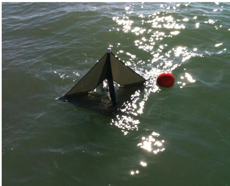
Figure 58 : Bouée dérivante et sa voile avant immersion.
