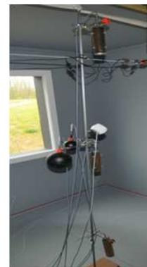
a) Schéma de l'installation des sondes de mesures de températures d'air
