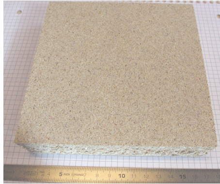
Figure 2.4 – Éprouvette d’aggloméré de lin utilisée pour les essais de transfert thermique.
