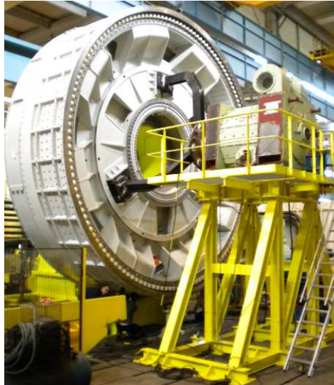
Figure 5.17 Banc de test essai à vide avec machine à courant continu
