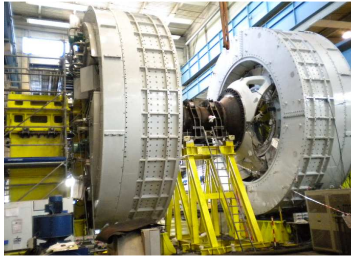
Figure 5.25 Photos des machines pendant les essais « back to back »
