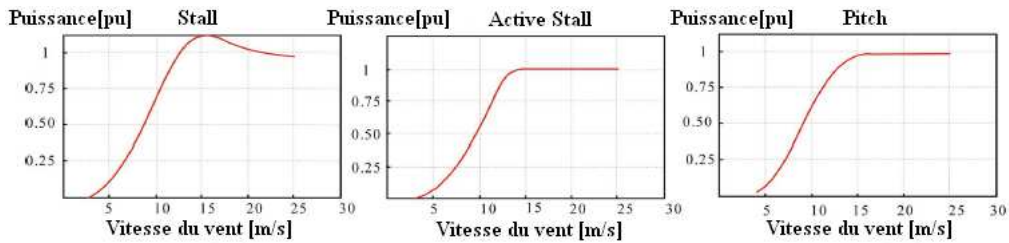
Figure 1.14 Comparaison des caractéristiques de puissances pour les différents systèmes d'inclinaison des pales (extrait de [Che09])
