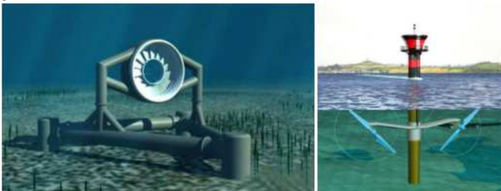
Figure 1.10 Les concepts d'hydroliennes « open hydro » [Ope12] (à gauche) et « Seagen » [Sea12] (à droite)
