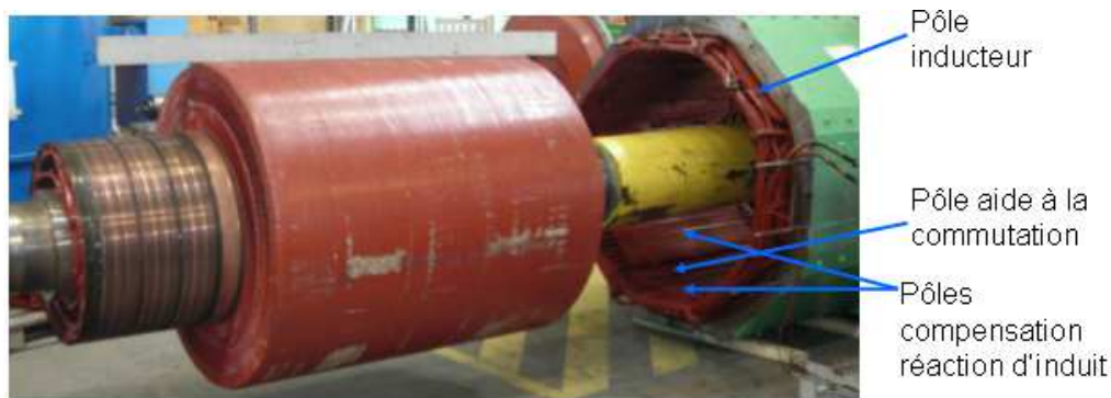
Figure 4.6 Photos d'une machine à courant continu (insertion de l'induit)
