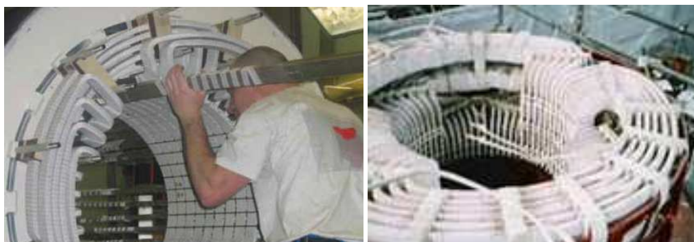
Figure 2.11 Bobines de type « diamond coil » (en haut) et « hairpin coil » [Coi11][Eri12] (en bas)
