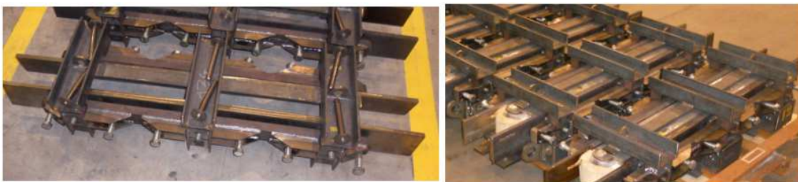
Figure 3.16 Coffrages utilisés pour la polymérisation des plots
