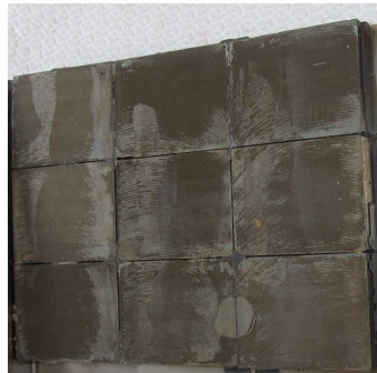
Figure 2.19 Exemple de collage de plusieurs blocs d'aimants identiques pour l'obtention d'un pôle
