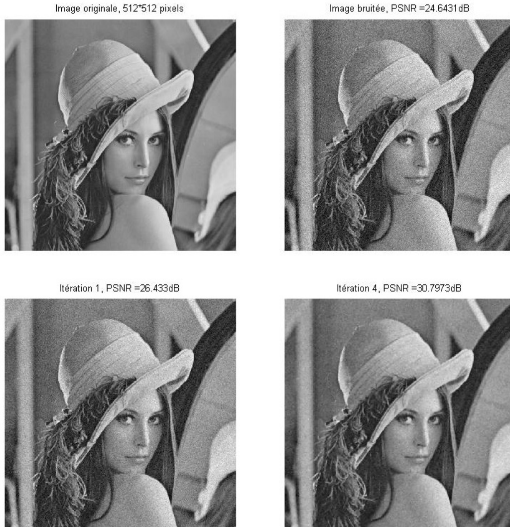
FIGURE 4.3 – Application itérative de la méthode à neuf points d’interpolation L_1 à \delta près avec \lambda = 100 , \delta = 5 .
