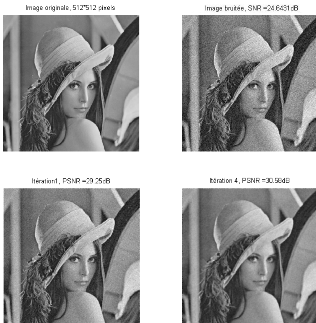
FIGURE 4.8 – Application itérative de la méthode à cinq points d'interpolation L_1 à \delta près avec \lambda = 100 , \delta = 5 .
