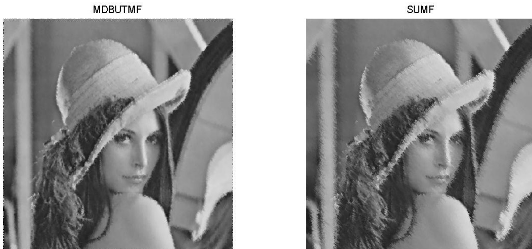
FIGURE 4.12 – Restauration de l’image de Lena corrompue par un bruit de type ”poivre et sel” sur 80% des pixels grâce aux méthodes SUMF et MDBUTMF.
