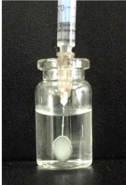
Figure 19. Des organogels des acides gras (acides myristique, palmitique, stéarique et arachidique) et l'huile de soja préchauffés et injectés dans l'eau à 37 °C (Wang et al., 2014)
