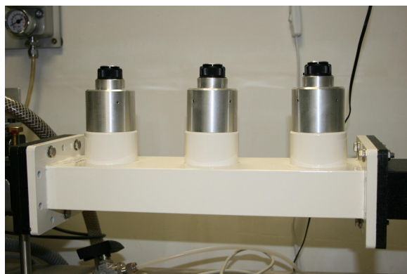
Figure C.20 – Adaptateur d'impédance consistant en trois stubs ajouté en avant de l'applicateur sur la cavité micro-ondes monomode
