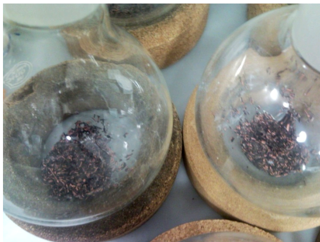
Figure 105 – Étape de traitement des échantillons par le cuivre dont la fraction en excès reste rose alors que le cuivre noirci constitue la fraction qui a réagi avec le soufre
