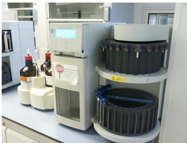
Figure 101 – Appareil d'extraction accélérée par solvant (ASE-Dionex 200)
