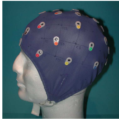
Figure 4.9: Exemple de casque utilisé pour récupérer le signal EEG [Cas ].
