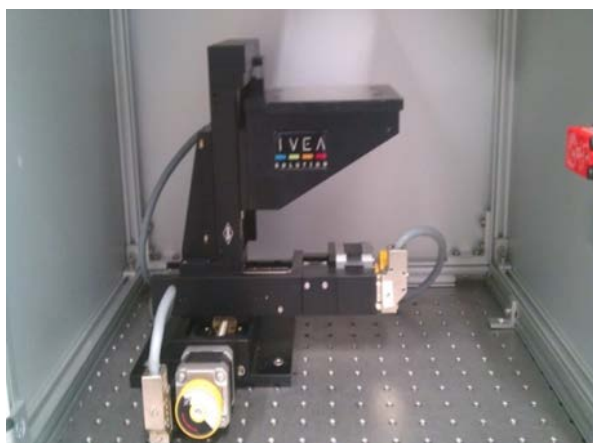
Figure 3. 9 : Intérieur de la chambre d'analyse des solides + Table XYZ
