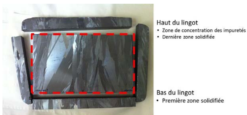
Figure 3. 25 : Partie du lingot retenue pour l'analyse (entourée en rouge)
