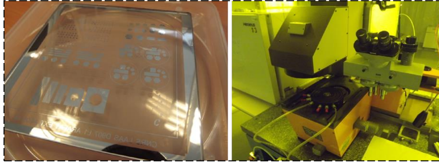
Figure IV-7 Masque en chrome/verre et machine à UV (SETMA702)
