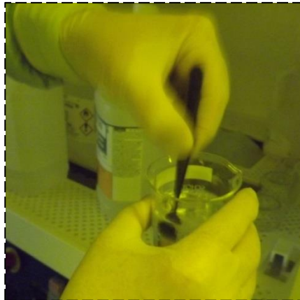
Figure IV-8 Substrat placé dans le révélateur pour enlever la résine exposée à l'UV
