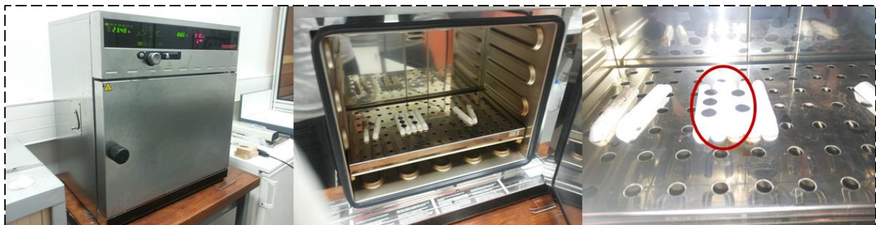
Figure II-12 Four pour le recuit des échantillons de tout type.
