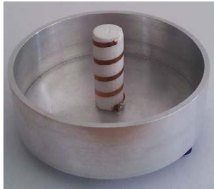
Figure 57 Prototype de l'antenne hélice dans le réflecteur cylindrique
