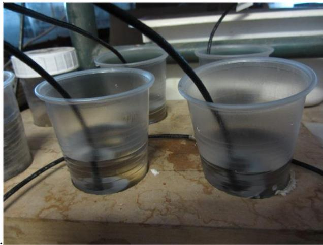
**Figure II. 23: Conservation des tensiomètres**
