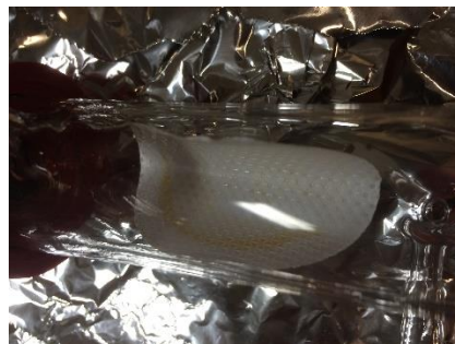
Filtre après exposition des particules de sulfate d'ammonium acidifiées à l' \alpha -pinène (1,0 ppm) pendant 90 min
