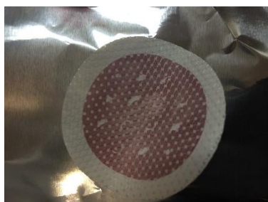
Filtres après exposition des particules de sulfate d'ammonium acidifiées à l' \alpha -pinène oxyde (3,3 ppm) pendant 140 min (à gauche) et 400 min (à droite)
