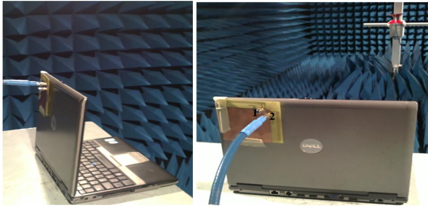
Figure 4.50 : Positionnement du système antennaire à base de IFAs sur un ordinateur portable.
