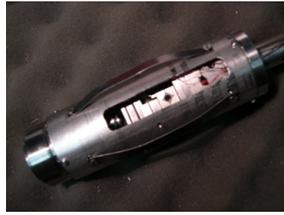
FIGURE 2.4: Extrémité de la canne contenant l'objectif de microscope, le scanner piézo-électrique avec l'échantillon et les nano-positionneurs piézo-électriques.
