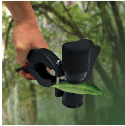
FIGURE 11: PINCE SPECTROCLIP D'OCEAN OPTICS QUI INTEGRE DE MINI SPHERE INTEGRANTE POUR REALISER DES MESURES DE DHRF ET DE DHTF SUR LA FEUILLE. MALHEUREUSEMENT CETTE PINCE N'EST PAS ENCORE AU POINT: NOUS L'AVONS TESTE ET N'AVONS PAS REUSSI A OBTENIR UN SPECTRE DE FEUILLE EXPLOITABLE.
