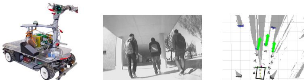
Figure 1.32: (Gauche) Robot utilisé pour l'acquisition des données, (centre) extrait d'une vidéo enregistrée par la caméra (droite) représentation des mesures laser avec les 3 personnes détectées et leur vitesse. Le robot est représenté par le rectangle.
