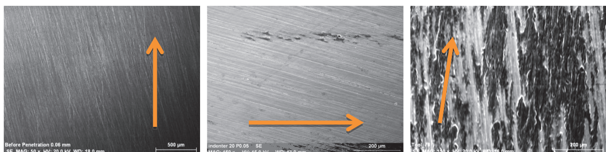
Figure 33 : Micrographie de la surface du frotteur. Polissage non parallèle au sens de glissement (a) avant essai ; (b) après essai, pénétration p = 60 \mu\text{m} , vitesse = 10 \text{mm}\cdot\text{s}^{-1} , lubrifié ; (c) après essai, pénétration p = 120 \mu\text{m} , vitesse = 60 \text{mm}\cdot\text{s}^{-1} , lubrifié (la flèche orange indique le sens de glissement)
