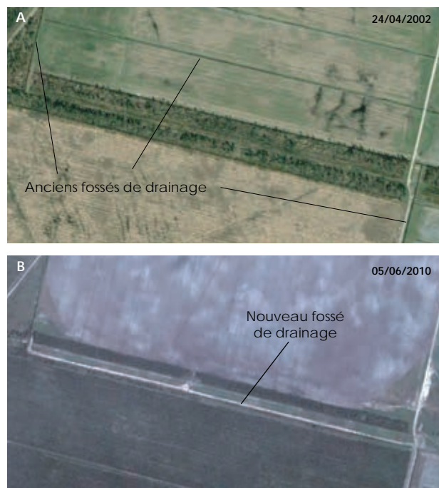
Fig. II.1 : Exemple de la stratégie adoptée pour l'identification de nouveaux fossés en utilisant les clichés Google Earth. A : Marge de champ cultivé avec d'anciens fossés de drainage (Image du 24/04/2002) ; B : Même secteur, image prise le 06/06/2010. Un nouveau fossé a été creusé en marge du champ et il apparaît clairement sur l'image.
