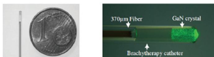
FIGURE 1.21 – Sonde dosimétrique GaN développée pour la radiothérapie externe [7].
