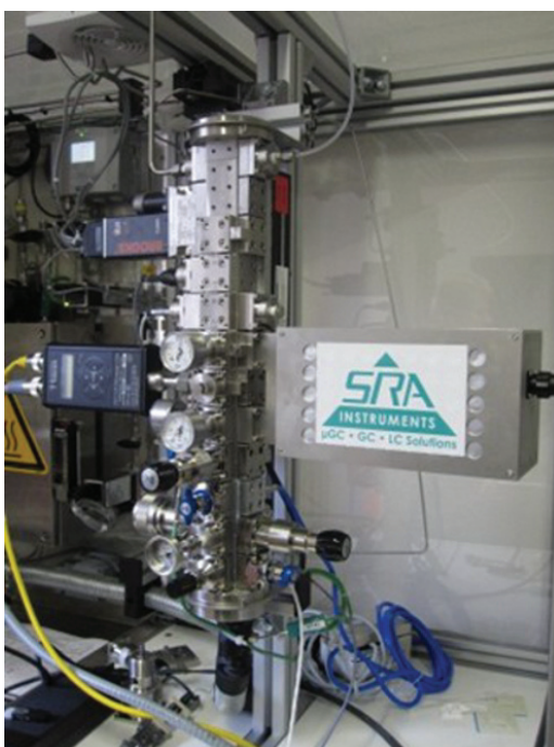
Figure 4 : Micro-chromatographe SRA Instrument monté sur platine Astute
