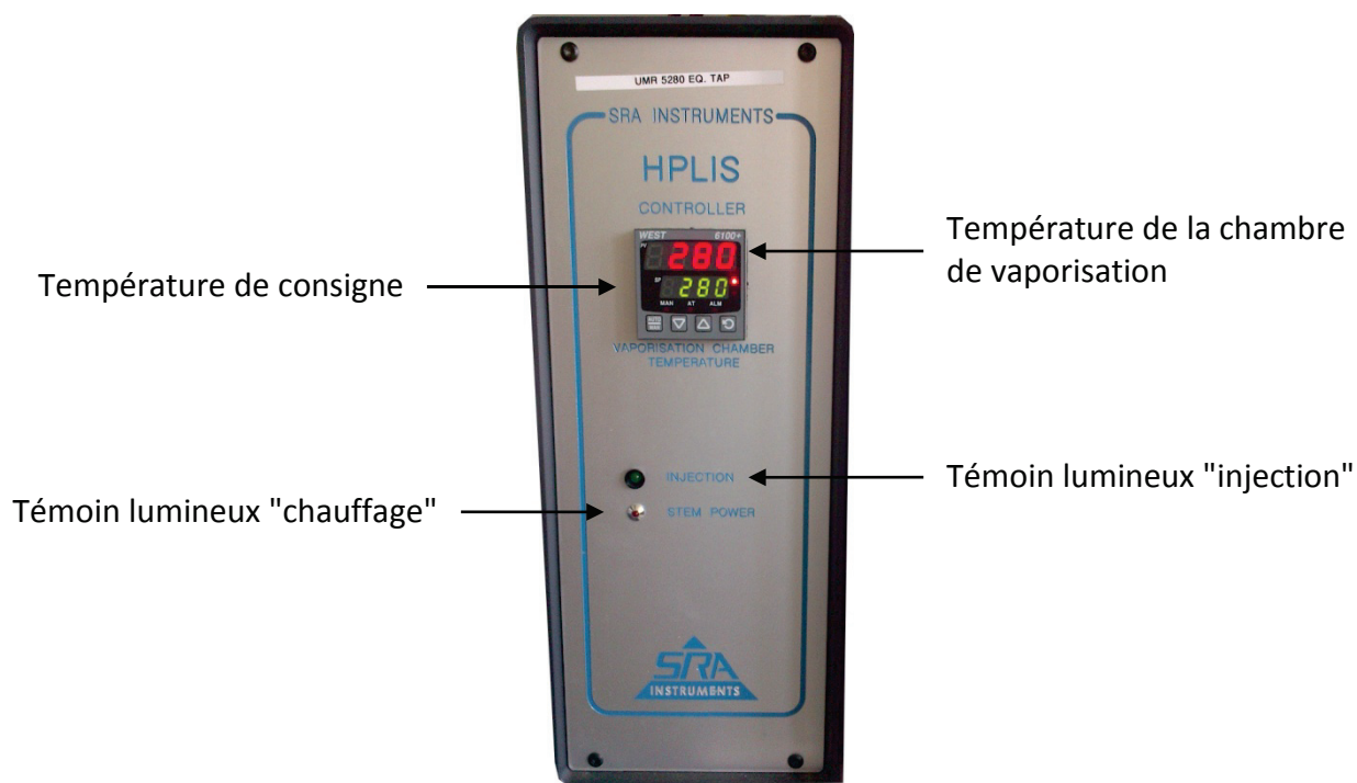
Figure 18 : Photographie du boîtier de commande de la vanne HPLIS
