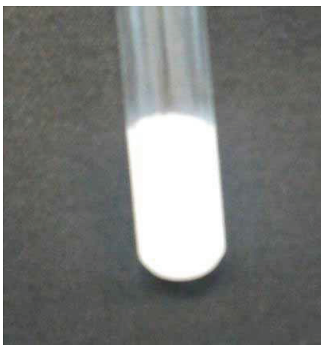
Figure 3. Suspension de particules de polycaprolactone stabilisées par le copolymère à blocs PCL 65 - b -PEG 113 .
