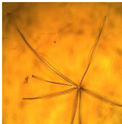
Figure IV- 18 : Images de film fabriqué par séchage de goutte sessile de mélange PBMA/PBMA-R10% pour une fraction de PBMA \Phi_{\text{PBMA}} = 0.52 à 40°C. Les premières craquelures sont localisées au centre du film.
