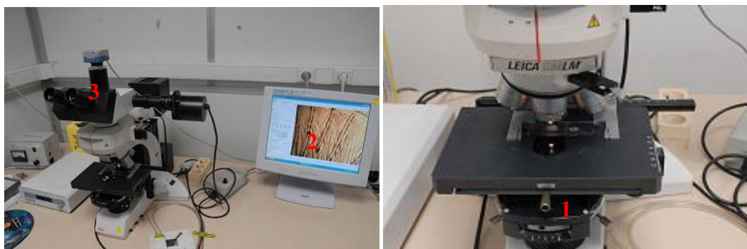
Figure II 13 : Microscope Leica avec une caméra digitale Motic couplée à un ordinateur : (1) L'échantillon, (2) Image du film, (3) Caméra digitale.
