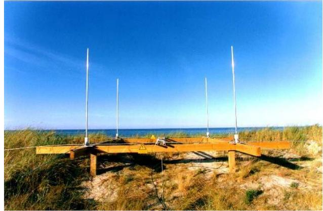
Fig. 4 : Radar WERA à quatre éléments.
