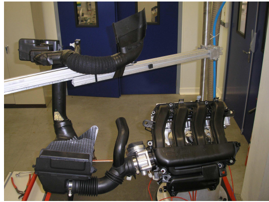
Figure 5.29 – Essai Banc Dynamique - Ligne d'admission K4M complète
