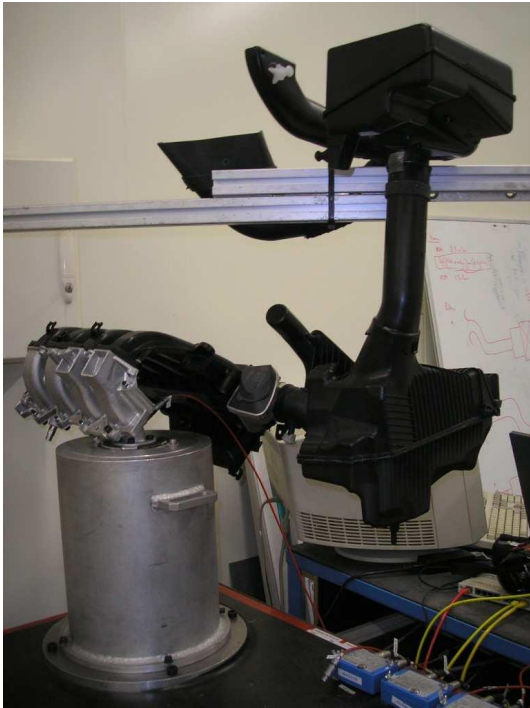
Figure 5.28 – Essai Banc Dynamique - Ligne d'admission K4M complète
