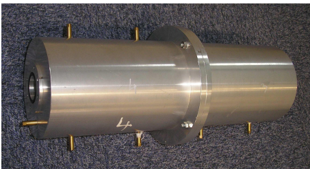
Figure 2.3 – Volume en 2 demi-coques 2*200 mm diam. 120mm
