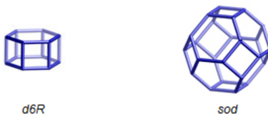
Fig.4: Unités de construction dont l'assemblage régulier est à l'origine du type structural FAU 7
