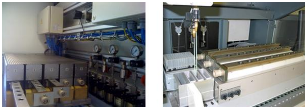
Fig.2: Photographies d'une unité de chauffe de l'outil d'expérimentation à haut-débit et des barres de réacteurs utilisées (gauche) ainsi que du robot de préparation des gels de synthèse (droite)
