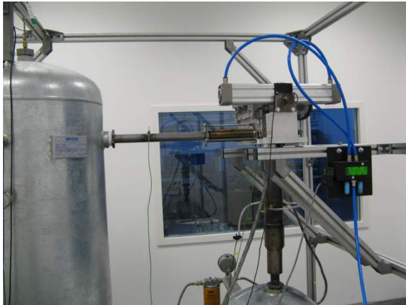
Figure II-8. Vue du montage permettant les essais instationnaires en configuration échappement
