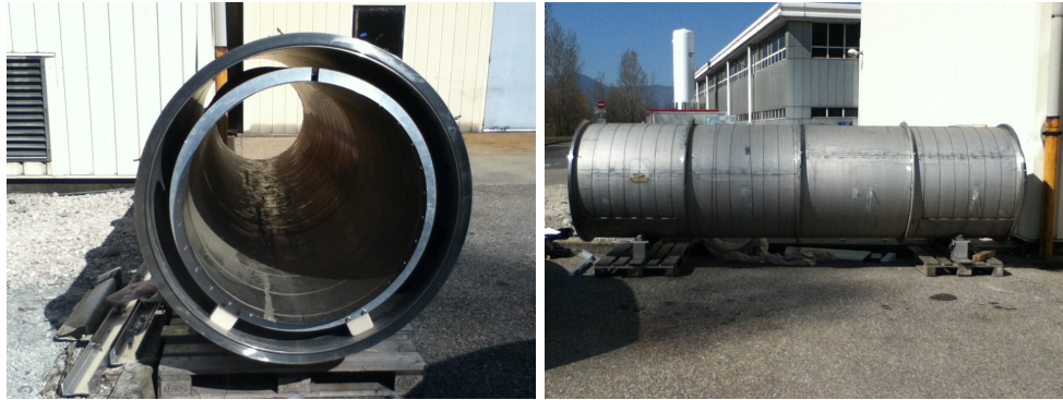
FIGURE 4.3 – Blindage magnétique utilisé dans notre expérience. Le cylindre intérieur est constitué de \mu -métal, le cylindre extérieur est en aluminium.
