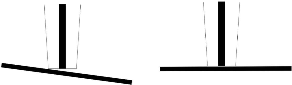
Figure A 2. Schéma représentant de la distance minimale électrode-surface (a) avec une inclinaison de la surface et (b) avec une électrode et une surface parallèle.  $d_{\min,a} > d_{\min,b}$ .
