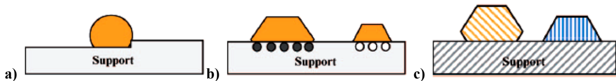
Figure 17 : Schéma de particules de la phase active ancrées a) par une barrière physique, b) par la présence de défauts et d'impuretés et c) par épitaxie, d'après [53].
