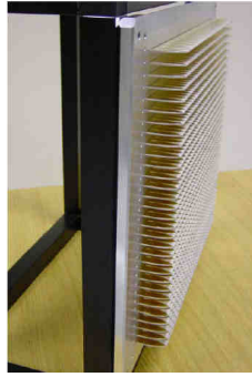
Figure 2-24 : Réseau d'antennes Vivaldi de 31 \times 31 antennes mono-polarisation [77].
