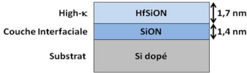
Figure 1.7 : Schéma de l'oxyde de grille High-k utilisé pour le transistor du nœud 28nm. L'oxyde possède une structure bicouche en raison de la couche interfaciale nécessaire pour les performances du dispositif.
