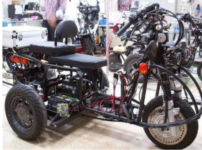
FIGURE I.4 – Illustration du robot présenté dans l'article [7] : Un véhicule étroit capable de déplacer latéralement son centre de masse par rapport à la position de ses roues.
