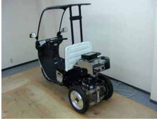
FIGURE I.3 – Illustration du robot présenté dans l’article [11] : Un véhicule étroit capable de déplacer latéralement son centre de masse par rapport à la position de ses roues.
