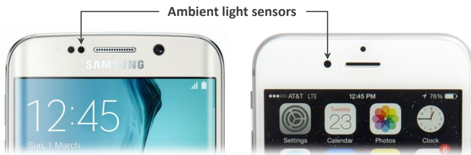
FIG. 1.11. Examples of ALS sensors in the Samsung Galaxy S6 Edge and in the Apple iPhone 6.
