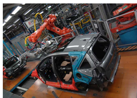
Figure I-5 : Pose automatisée du pare-brise
