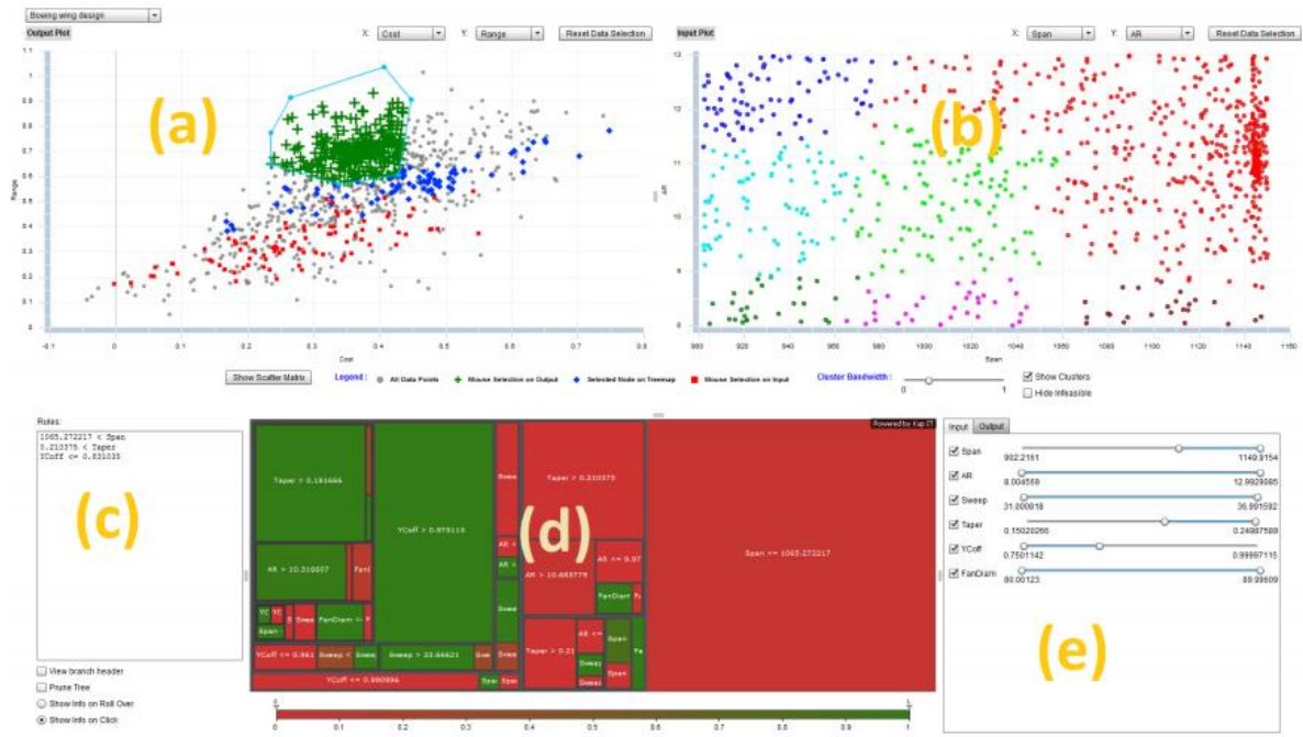
Figure 16 : Impressions d'écran de l'outil LIVE: (a) scatter plot des variables de performance; (b) scatter plot des paramètres de conception (montrant des clusters de résultats); (c) règles de décision; (d) treemap de l'arbre de décision; (e) sliders ajustables des intervalles des variables.
