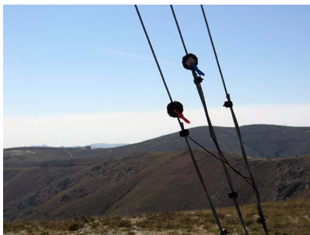
FIGURE 3.5: Le microphone contact piézoélectrique permet de capter les vibrations émises par un corps solide
