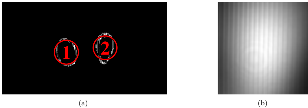
Figure 4.15 – Résultats de la première étape de l’algorithme d’extraction de la modulation des interférences appliqué à la fig. 4.14(b) : (a) un grossissement de l’image initiale avec la détection des différents faisceaux et (b) l’image découpée autour du faisceau d’intérêt.
