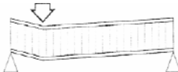
Figure 2.9. Rupture par cisaillement transversal
