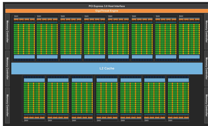
FIGURE 1.8 – Digramme des principaux blocs du GPU Kepler GK110
