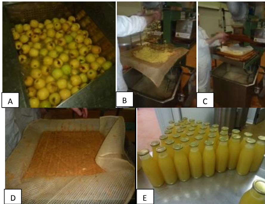
Figure 4 : Etapes de fabrication de jus de pommes. A/ Lavage, B/ Broyage, C/ Pressage, D/ Gâteau de presse, E/ Embouteillage (Source Agrotec).
